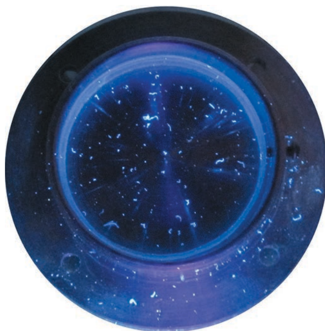
рисунок 5. Фото датчика с образцом-свидетелем из кварцевого стекла после проведения ТВИ. В результате освещения с помощью УФ-лампы хорошо видны присутствующие на его поверхности загрязнения
