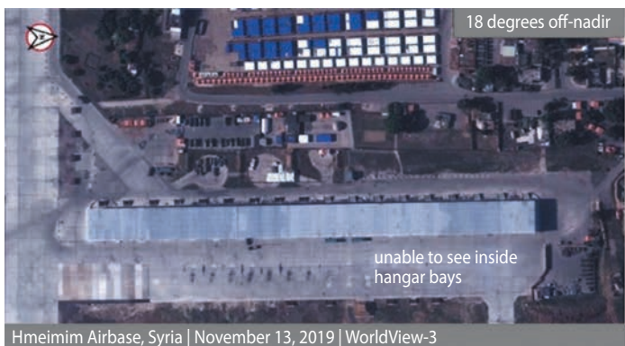
рисунок 12. При угле визирования 18 градусов (снимок слева) наличие транспорта в ангаре не определяется; при угле визирования 62 градуса (снимок справа) – определяется
