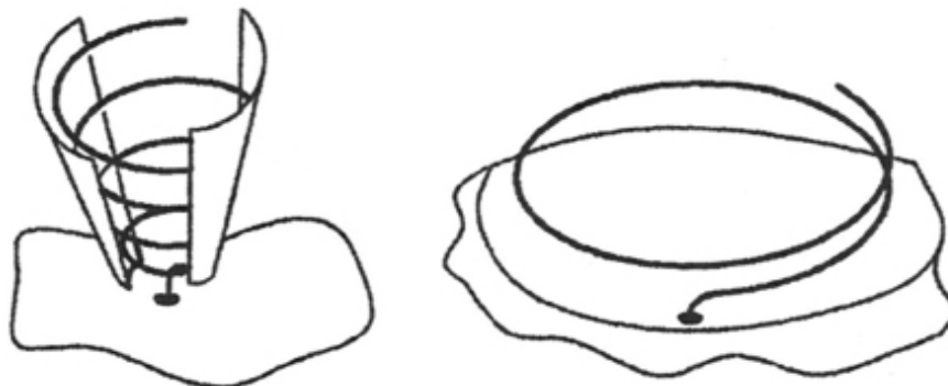
рисунки 6. Спиральная антенна, заключенная в отражающий конус
