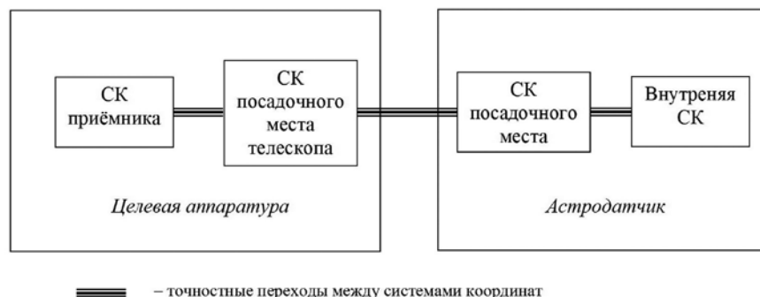
рисунок 1. Точностные переходы между астродатчиком и целевой аппаратурой
