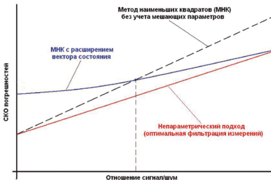
рисунок 2. Зависимость погрешностей от уровня шумов при применении различных методов обработки измерений
