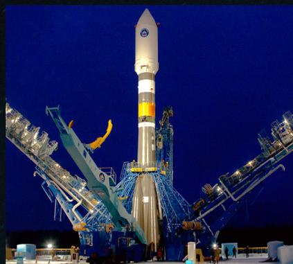
РН среднего класса «Союз-2.1б» создана в ракетно-космическом центре «Прогресс» (входит в Госкорпорацию «Роскосмос»), имеет двигатель 3-й ступени с повышенными энергетическими характеристиками, улучшенную точность выведения, устойчивость и управляемость, увеличенную массу полезной нагрузки.
