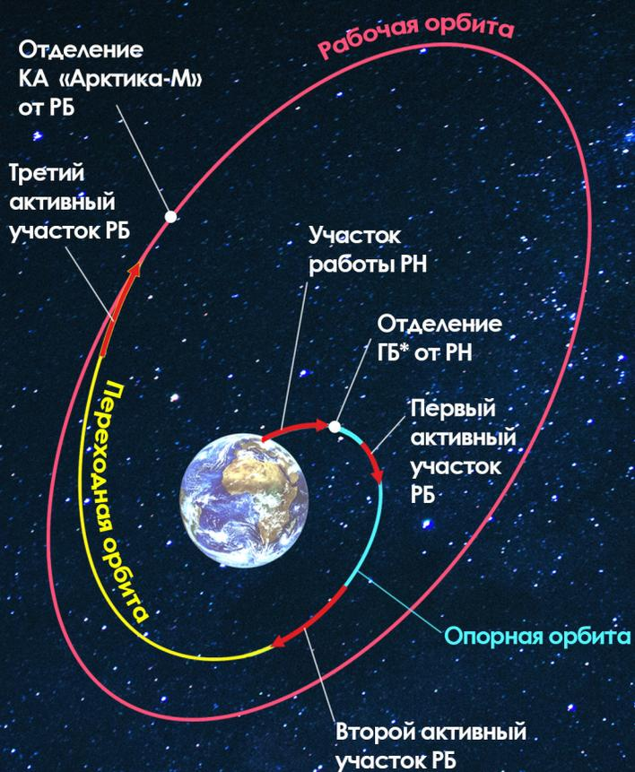
КА «Арктика-М» выводится непосредственно на рабочую орбиту - высокоэллиптическую орбиту типа «Молния».
